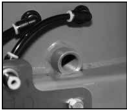
Fan Drain Connection
