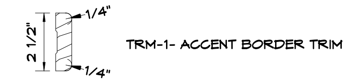
TRM-1 DETAIL SCALE: 3" = 1'-0" 5 A2.1
